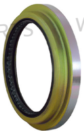
ซิลล้อหลังใน ISUZU TAY 113x156x26 BUS 200แตรง
